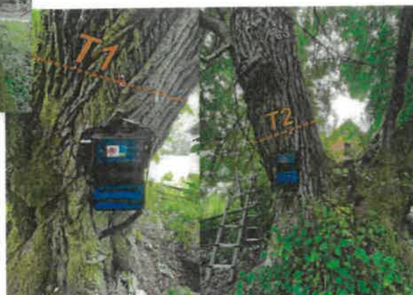
Fot. 17, 18. Badania budowy wewnętrznej pni przewodnikowych tomografem akustycznym T1, T2 - powierzchnia przekroju poprzecznego pnia w miejscu badania (linia przerywana) i nr pomiaru
